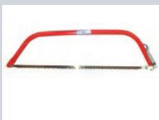
*Ručni alat za uzdužno i poprečno rezanje*
