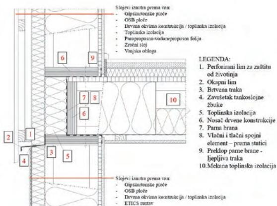
**Slika 54** Moguće rješenje vertikalnog presjeka vanjskog zida i međukatne konstrukcije bez izvođenja dilatacije ETICS-a
