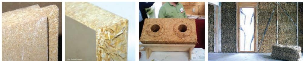
Slika 78 Proizvodi od slame, slama kao ispuna drvene konstrukcije
