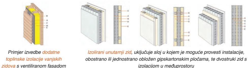
Dodatna toplinska izolacija unutarnjih zidova i zidova između dva stana izrađenih od ploča križno lameliranog drva uključuje **sloj u kojem je moguće provesti instalacije**, obostrano ili jednostrano obložen gipskartonskim pločama, te dvostruki zid s izolacijom od mineralne vune u međuprostoru čime se poboljšava prijenos udarne buke, ali i povećava otpornost sustava na požar.
