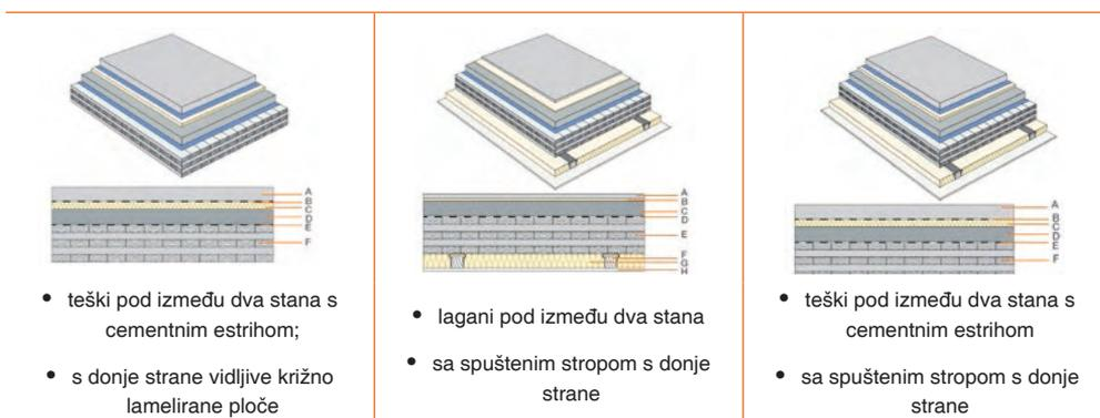
**Tablica 10** Moguća izvedba dodatne toplinske izolacije podova izrađenih od ploča križno lameliranog drva
